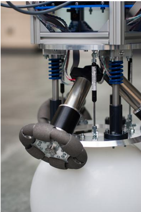
Abbildung 5 Antrieb: Motor EC-4pole 30, Planetengetriebe GP 42 C, Winkelencoder HEDL 5540, Omniwheel
